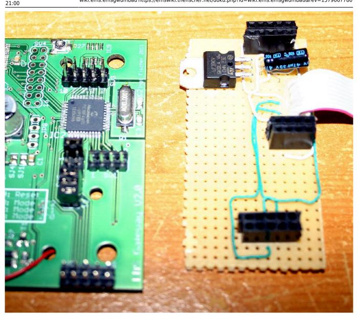
Das empfohlene Modul hat den Spannungswandler und die Pegelwandler bereits On-Board. Für andere Module gilt: Module mit 3,3 Volt benötigen noch zusätzlich einen 3,3V-Spannungsregler (200 mA!). Auch der 3,3 V ENC28J60 verträgt an den Eingängen 5V, so dass kein Pegelwandler benötigt wird. Es müssen SPI, CS und RES angeschlossen werden. Der genutzte TCP/IP Stack unterstützt die INT Leitung nicht, so dass der Port B5 ggf. für andere Zwecke genommen werden kann.
