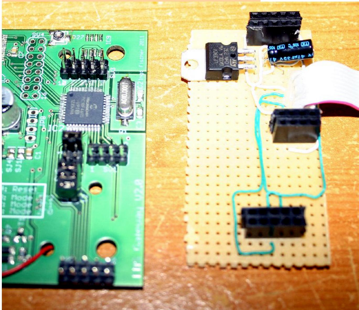
**Das empfohlene Modul hat den Spannungswandler und die Pegelwandler bereits On-Board.** Für andere Module gilt: Module mit 3,3 Volt benötigen noch zusätzlich einen 3,3V-Spannungsregler (200 mA !). Auch der 3,3 V ENC28J60 verträgt an den Eingängen 5V, so dass kein Pegelwandler benötigt wird. Es müssen SPI, CS und RES angeschlossen werden. Der genutzte TCP/IP Stack unterstützt die INT Leitung nicht, so dass der Port B5 ggf. für andere Zwecke genommen werden kann.
